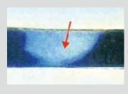
プリプレグの下に積層板 の銅箔がのこっている 顕微鏡倍率×
