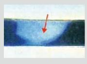
「コメント」 プリプレグの下に積層板の銅箔がのこっている 顕微鏡倍率×
