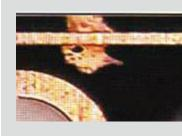
**【コメント】** プリプレグの下に積層 銅箔が残っている 顕微鏡倍率×
