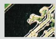
[コメント] 糊の下に残った積層板銅 箔が突起になっている 顕微鏡倍率× 80
